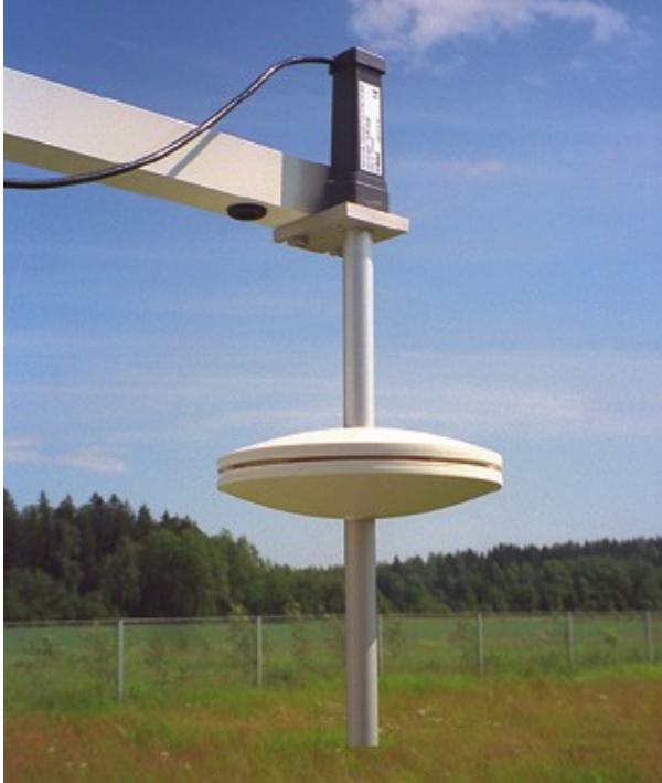
SPH10/20 容易安裝和連接。圖中為 SPH10 靜壓測棒與 PTB210 氣壓表的連接。
