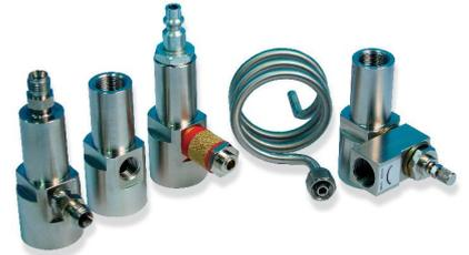
DMT242SC2、DMT242SC 和 DSC74 的取樣管（左起）可以直接用來將 DM70 與樣氣氣流連接。DSC74B（右）是一種雙壓力取樣管，可用於帶壓或常壓測量。DSC74C 取樣管含有冷卻/防漏螺絲，但是屬於選配範圍。
