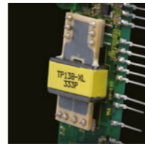
薄板式變壓器 使用纏繞線圈製成印刷電路板結構的超薄型板式變壓器，在不佔空間的情況下實現絕緣強度2000V AC。
